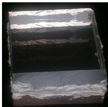
图 3.27: 三明治结构小样品照片。ESR 膜用透明环氧树脂胶固定于有机玻璃表面，极薄的一层白油被密封于 ESR 反射面和有机玻璃之间。
