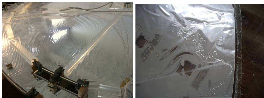
图 3.41: 在反射板原尺寸模型制作中，不可接受的贴膜缺陷。
