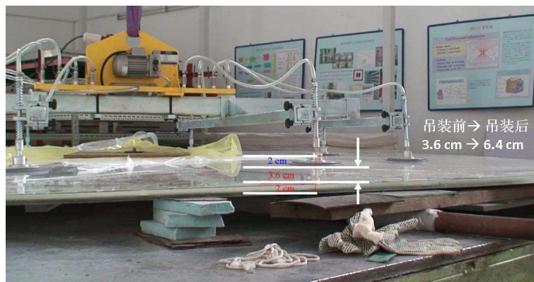
图 3.25: 反射板原型吊装试验。
