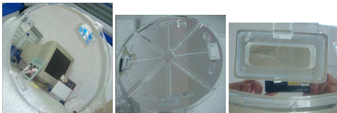
图 3.40: 与真实尺寸比例为 1:9 的下反射板原型样品。
