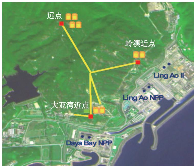
图 2.2: 大亚湾实验的反应堆和实验厅布局。实验厅之间以隧道连接。
