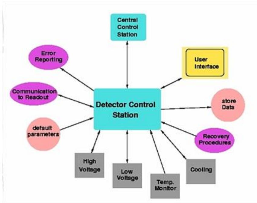
图 3 ATLAS Pixel Detector 探测器控制系统功能需求
