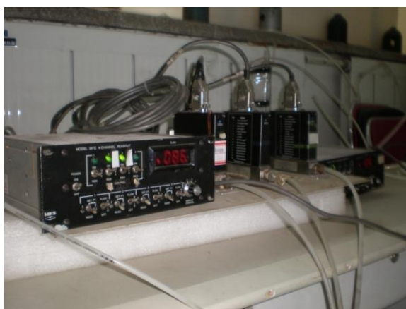
图 4.6 测试所用的 MKS 质量流控制器
