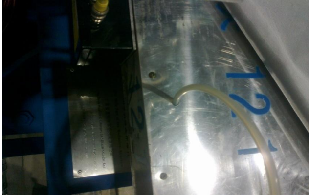
图 5.16 干燥气管插入模块内部
