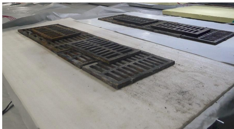
图 7.18 铁板加压测试实物图
