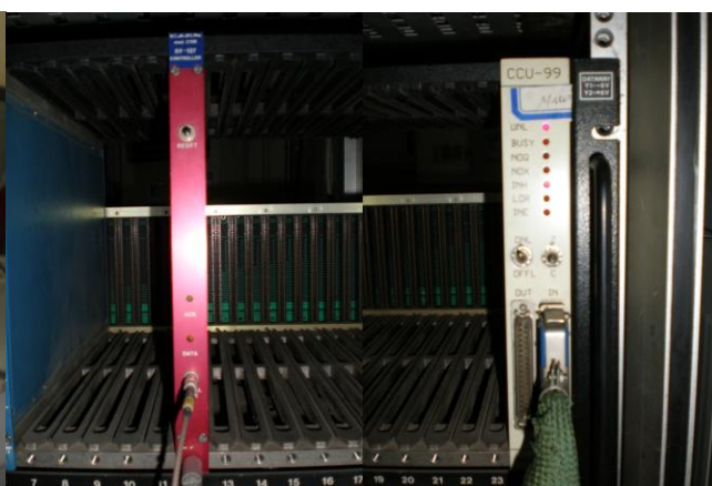
图 4.7 插件 C139、CCU99 和 ISA 总线的实物图
