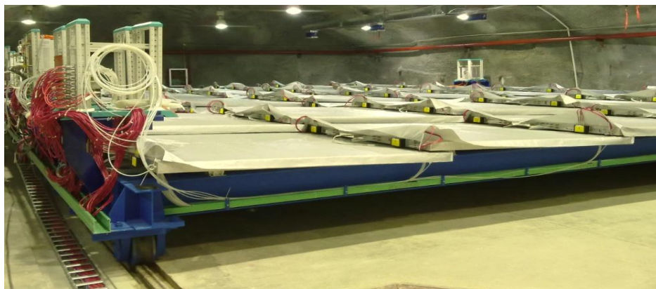
图 5.15 覆盖在模块上的阻燃防水布
