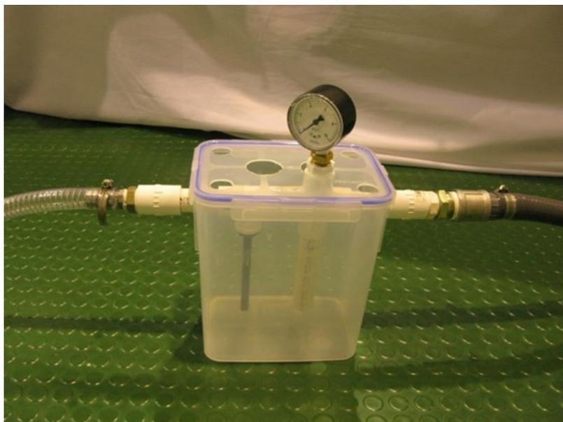
图 3.10: Pressure Relief Safety Bubbler，当罐内压力过高时，气体通过这个装置释放
