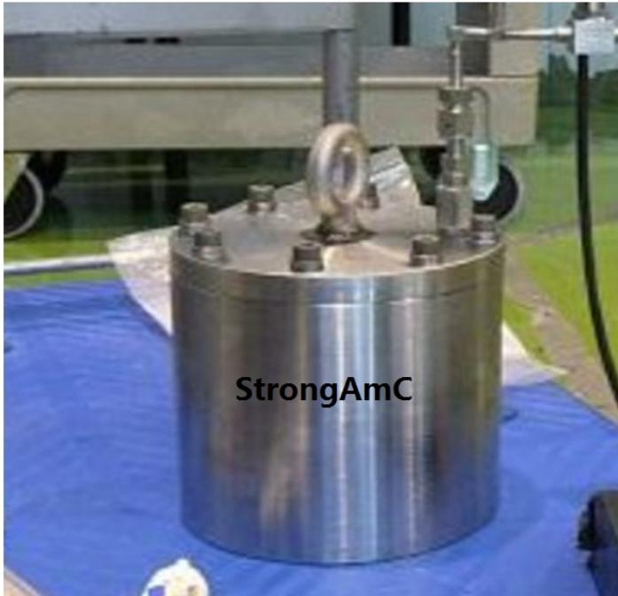
图 5.11: 强 AmC 源被包在一个不锈钢罐中。
