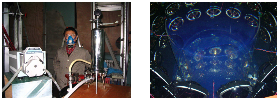
图 3.18: 模型本体液闪灌装设备与灌装后探测器: 左图为液体闪烁体灌装设备蠕动泵、过滤塔; 右图为液闪灌装完成后探测器的外观。
