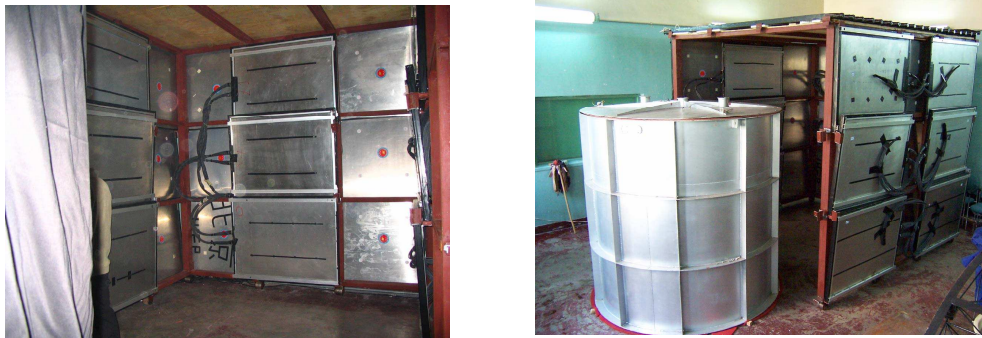
图 3.22: 模型实验反符合探测器外观：左图为探测器内部；右图为探测器外部，左侧为模型本体。钢架开口一侧将允许反符合探测器移动位置并将模型本体覆盖，之后再将其缺口面还原即为完整反符合探测器
