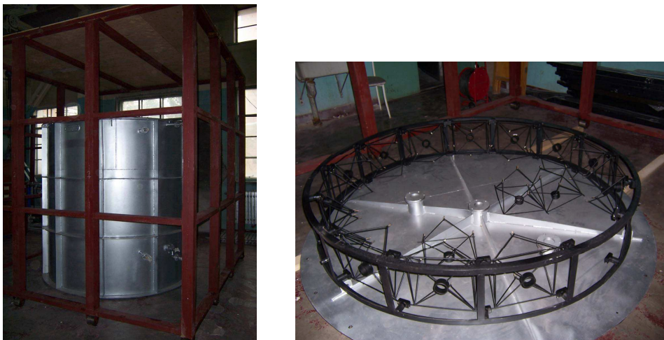
图 3.9: 建造完成的模型钢罐、反符合探测器骨架、 PMT 支撑环：左图内为钢罐，左图外为反符合探测器骨架，右图下为钢罐上盖，右图上为 PMT 支撑结构。
