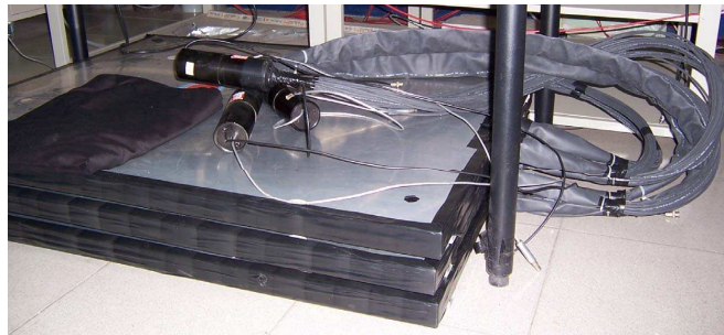
图 3.20: 模型宇宙线探测器闪烁体模块效率测量配置：上下两块闪烁体的逻辑“与”符合信号作为中间层模块的触发信号，测试中间层的 \mu 子探测效率，门宽 100ns 。
