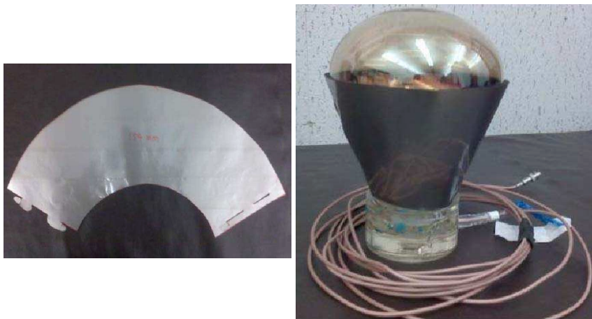
图 5.36: AD 内 PMT 磁屏蔽的结构设计。
