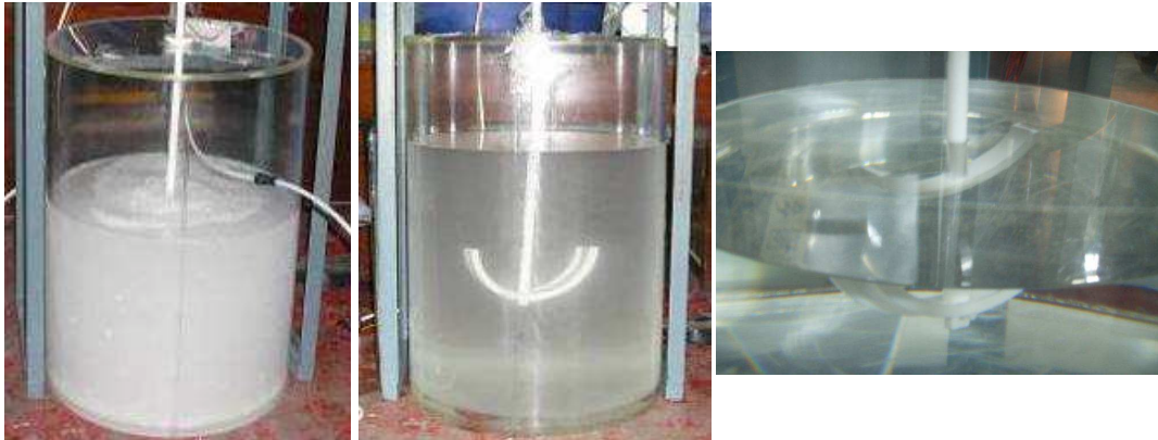
图 3.13: 钼固体络合物与 LAB 的溶解
