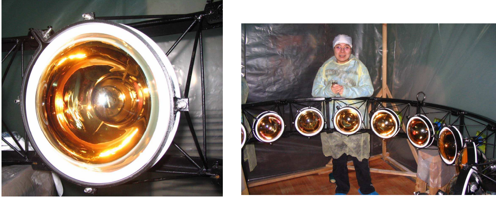
图 3.14: PMT 安装到支架上: 左图为单 PMT ; 右图为同一圈 PMT 安装完成后。
