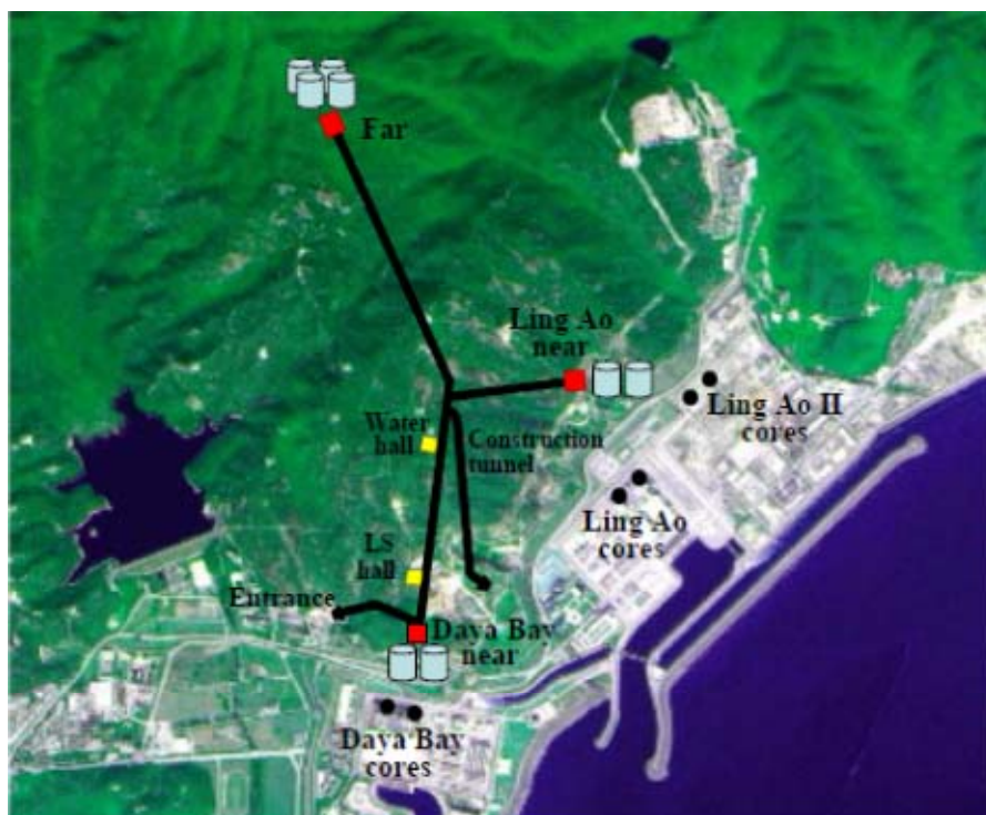
图1.4 大亚湾反应堆中微子实验布局图
