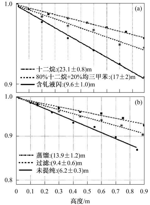
图4 (a) 不同条件下的均三甲苯的衰减长度曲线;
